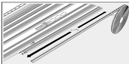
Fig. 46: Insertar una protección contra virutas nueva
