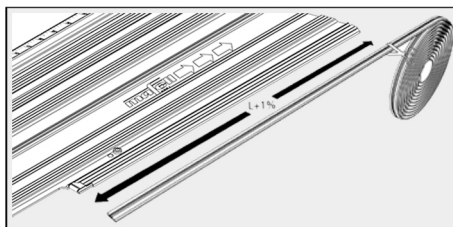
III. 29 : insertion du nouveau pare-éclats
