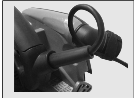
III. 26 : pose du câble de raccordement
