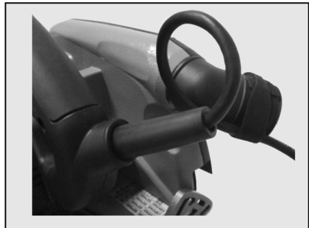
Ill. 20 : pose du câble de raccordement
