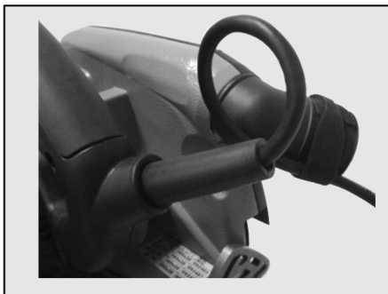
Ill. 20 : pose du câble de raccordement
