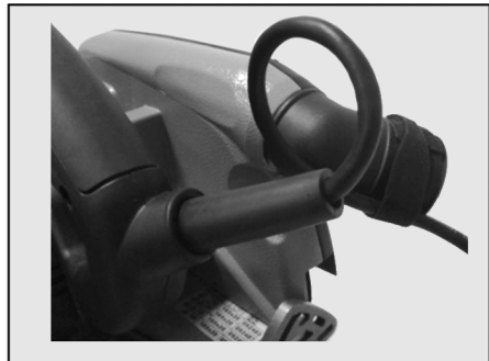
Ill. 20 : pose du câble de raccordement
