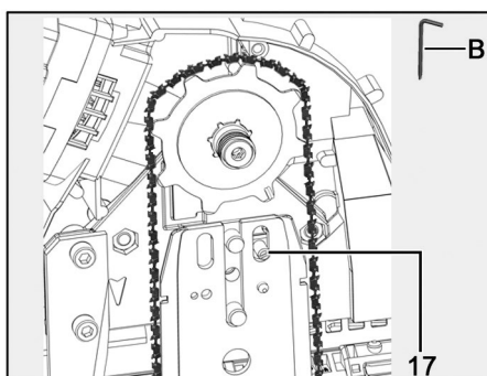
Fig. 87: Soltar la tensión de la cadena y quitar la espada de cadena junto con la cadena de sierra
