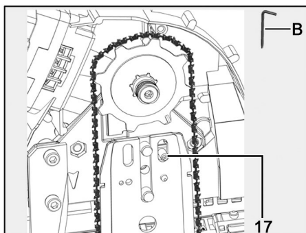
III. 47 : détendre la chaîne et retirer le guide-chaîne y compris la chaîne de scie
