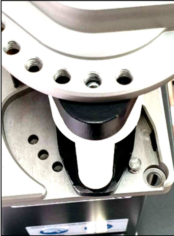
Abbildung 32 - Arretierung zum Ölen
