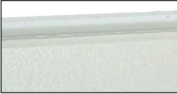
Abbildung 27 - Bsp. einer Verklebung, wie das Werkstück sich gut in die Funktionsschicht eindrückt.
