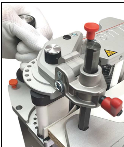
Abbildung 26 - Anfahren einer Kante
